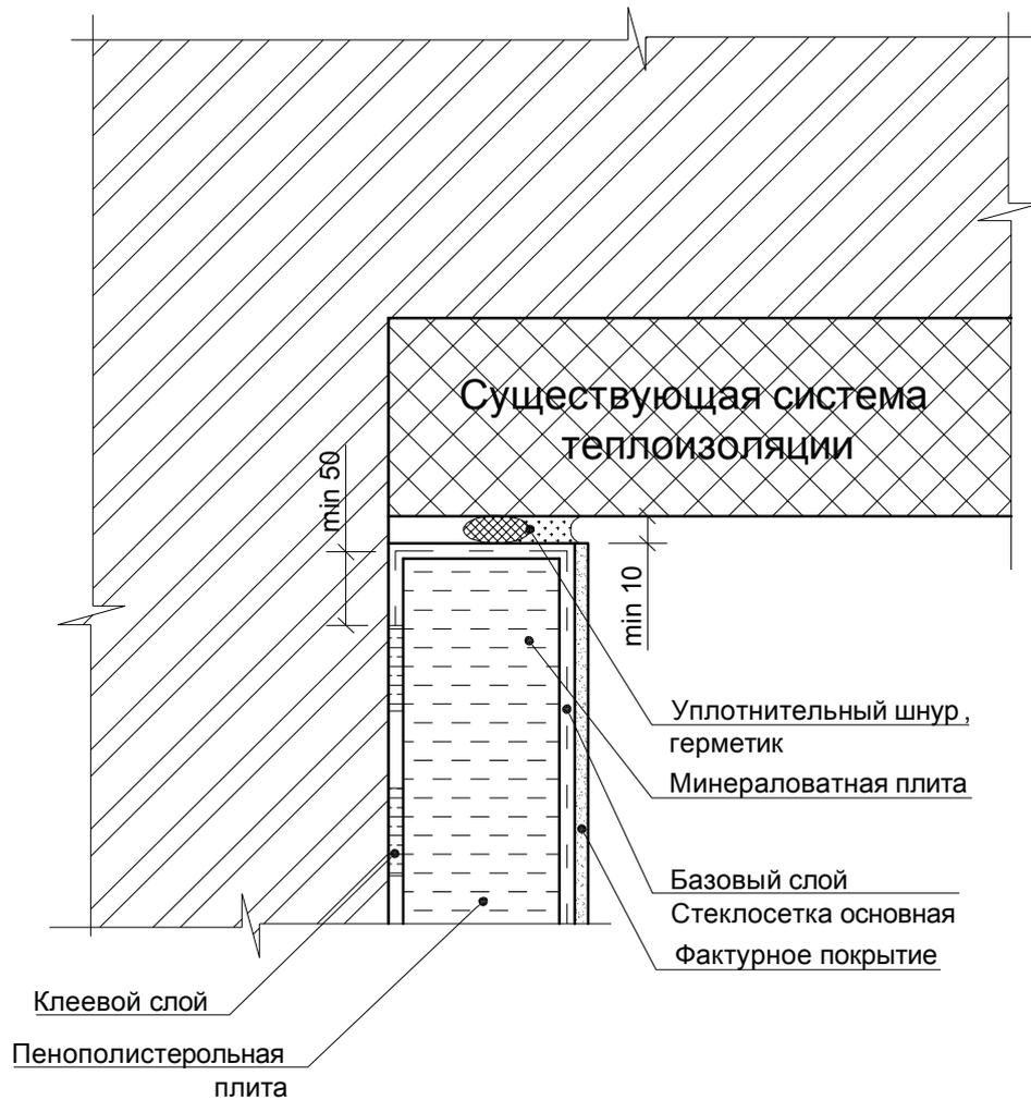
Примыкание системы к существующей системе теплоизоляции Holzer Therm MW
